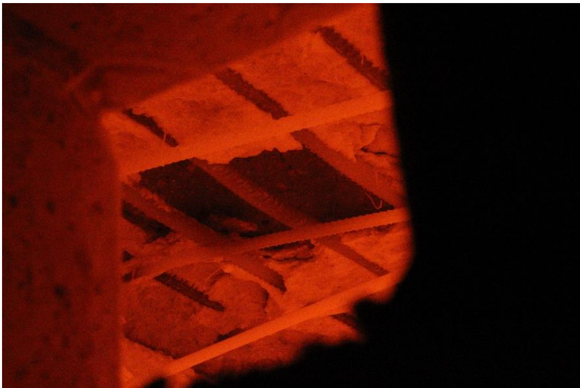
Figur 1. Spjälkning av betong från ett av de fullskaliga testen i studien vilket resulterar i armering fullt exponerad mot branden.
