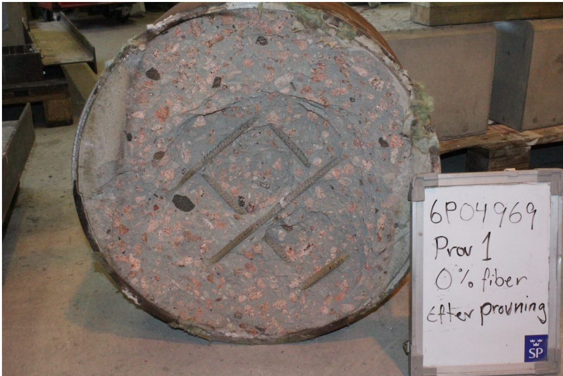
Figur 6. Provkropp som spjälkat efter att ha testats på miniugn.
