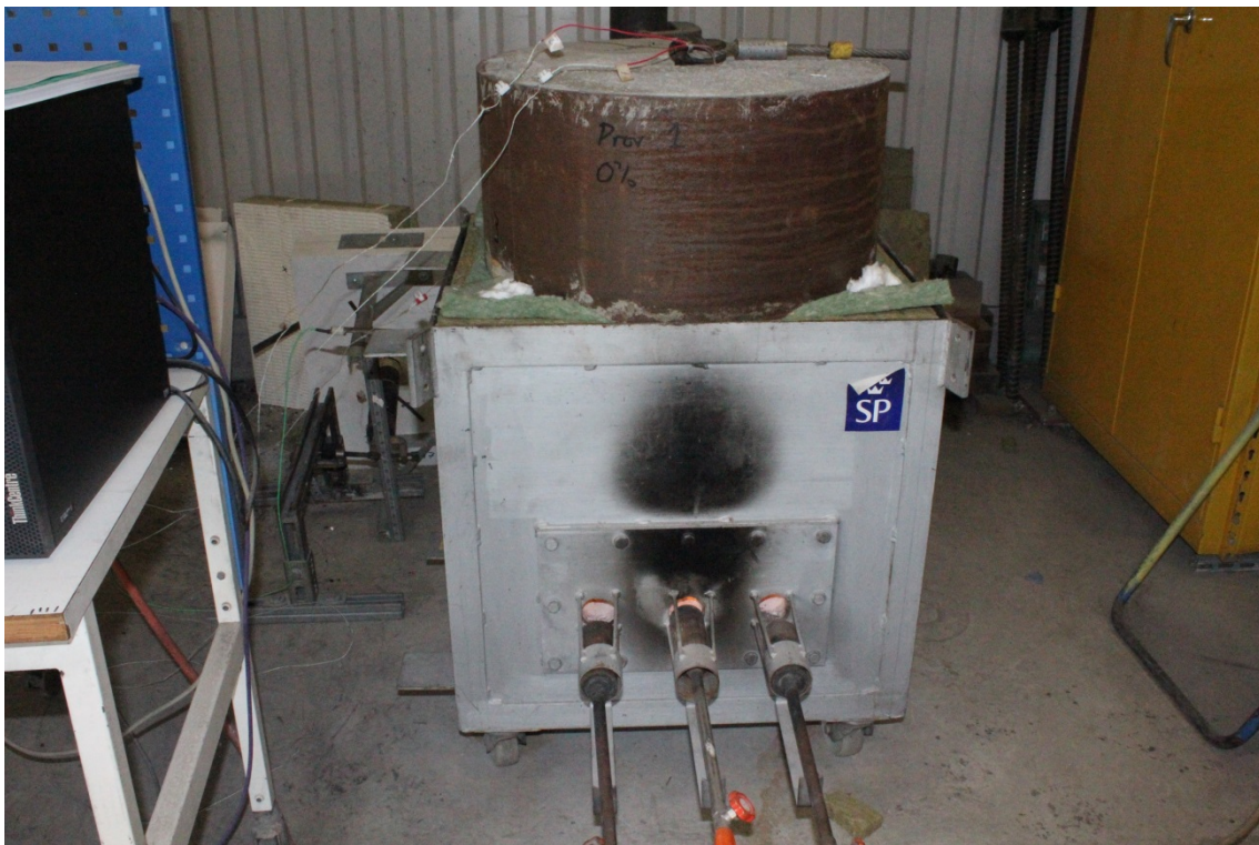
Figur 5. Mniugnsförsök på de cirkulära provkropparna vilket gav bäst korrelation mot fullskaliga tester.
